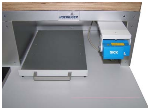
Barcodescanner mit Druckerfach / Barcode scanner with printer compartment
