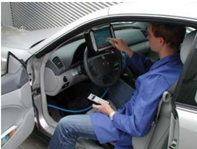
PortyEVOIII bei der Fahrzeugdiagnose
