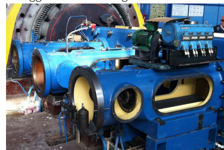
Zusammenbau von Kreuzkopflaufbahn und Kurbelgehäuse
