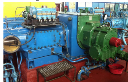
Neues Kurbelgehäuse und neue Kreuzkopflaufbahn in Betrieb
