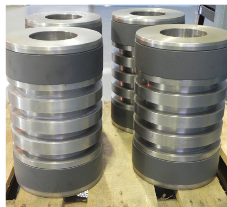
Modifizierte Kolben mit Schrumpfpassungs-Tragringen
