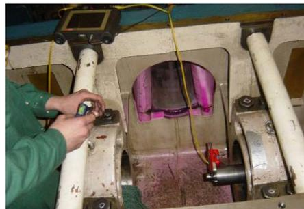
*Lasergestützte Ausrichtung und Bohren eines neuen Lagerstrasse*
