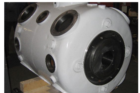
Neuer Kompressorzylinder nach der Endfertigung
