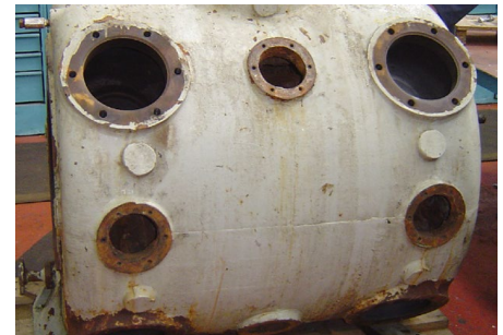
Beschädigter Zylinder ließ sich nicht mehr reparieren
