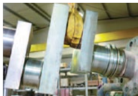
Kurbelwelle wird aus dem Gehäuse zwecks Inspektion entfernt
