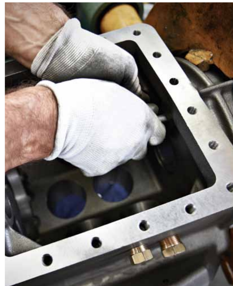
Hier werden die Kolben montiert.
