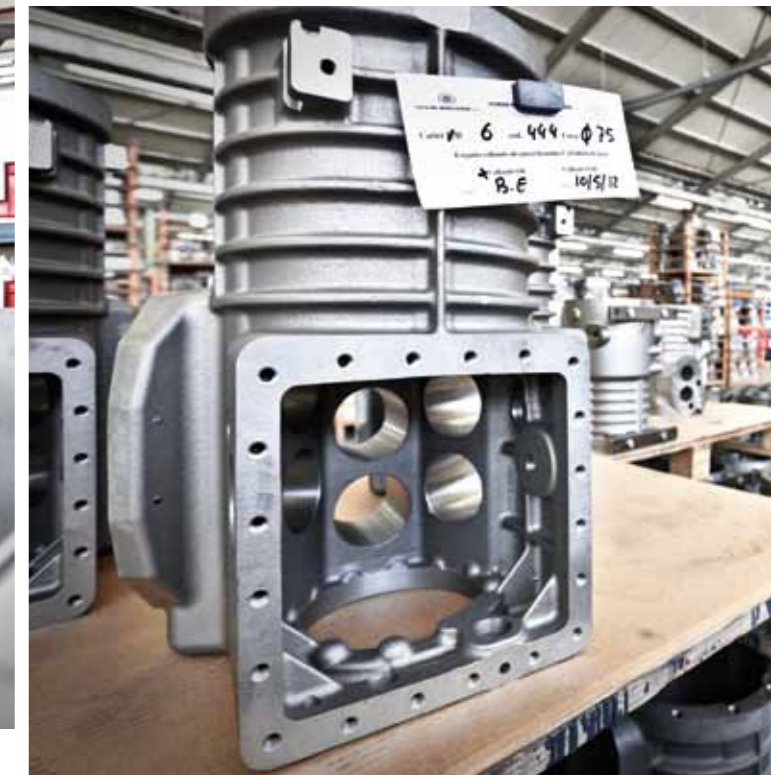
Ein Kurbelgehäuse steht für die weitere Bearbeitung bereit.
