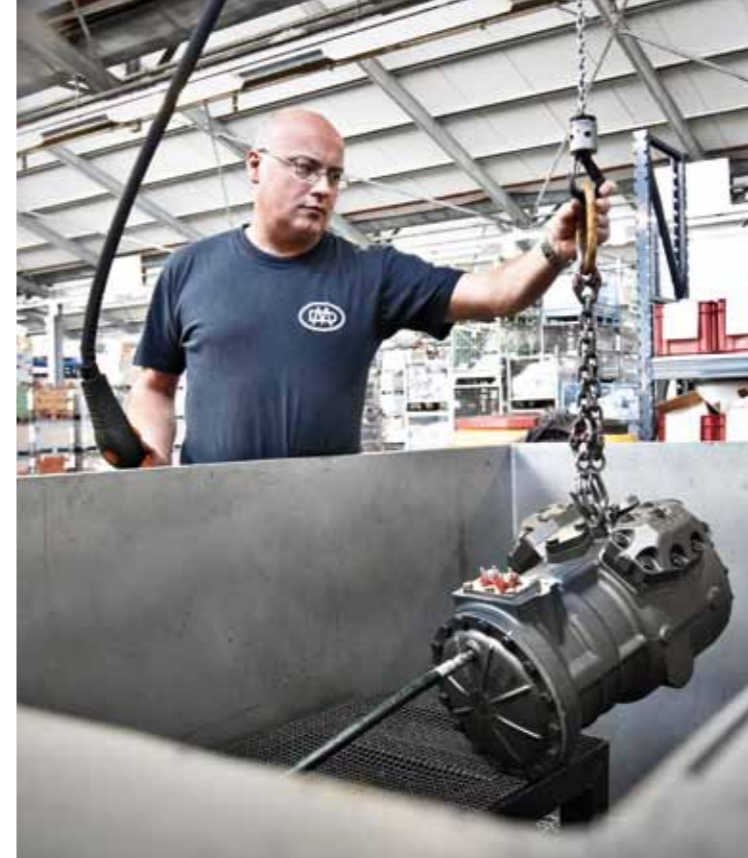
Der Kompressor wird bei maximalen Druck getestet.
