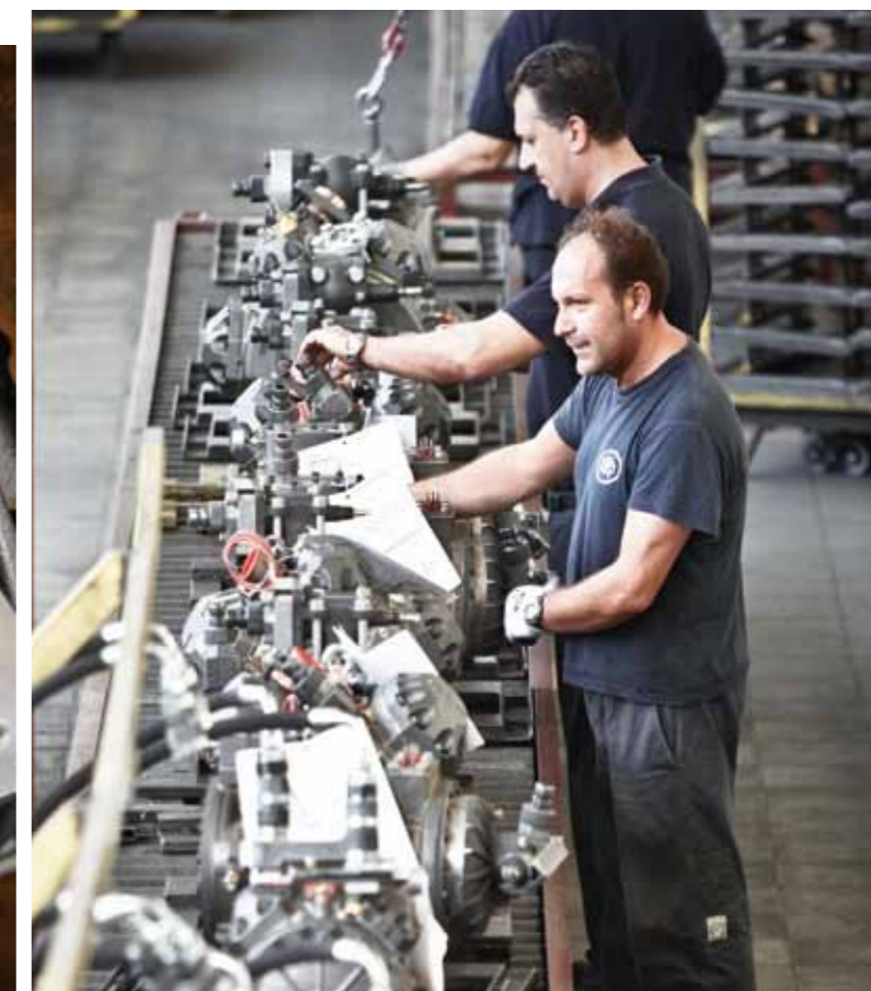
Die Kompressoren werden mit elektronischen Elementen versehen.
